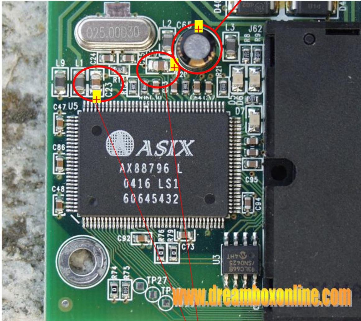
**Saldare in parallelo i condensatori al tantalio da 4,7uF (ATTENZIONE ALLA POLARITA' dei tre condensatori elettrolitici C17-C23-C65 !)**
